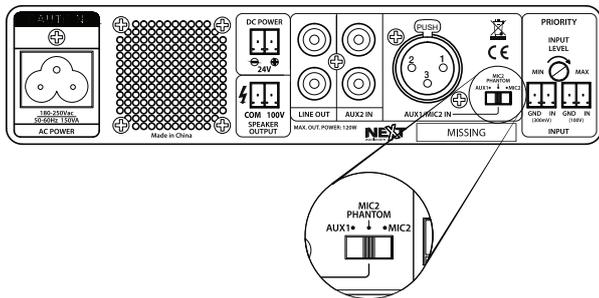
Quando estiver ativado o "Phantom Power", tenha cuidado ao escolher o cabo certo para o microfone. Deve ser um cabo balanceado para funcionar corretamente.
